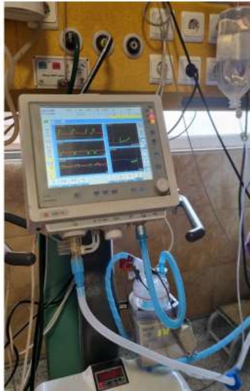
شکل ۳۶- اتصالات رطوبت ساز
