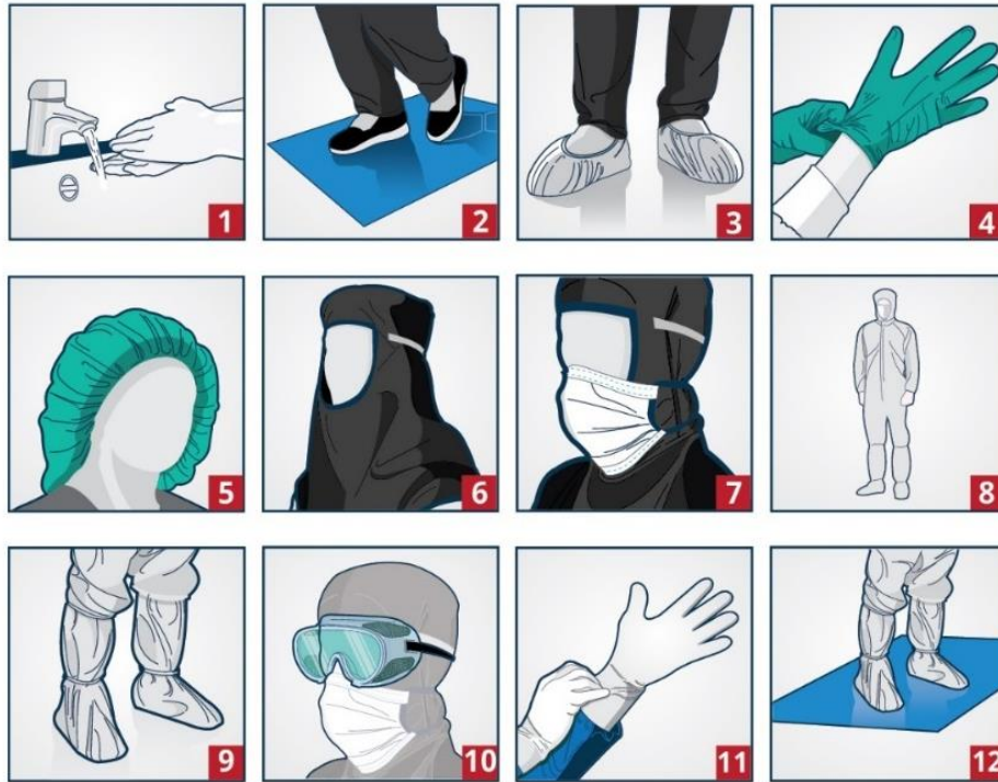
شکل ۳-۴. مراحل صحیح پوشیدن لباس اتاق تمیز
