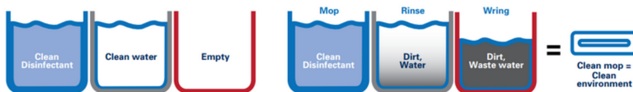
شکل ۳-۱. سیستم های پاک کننده چند سطلی
